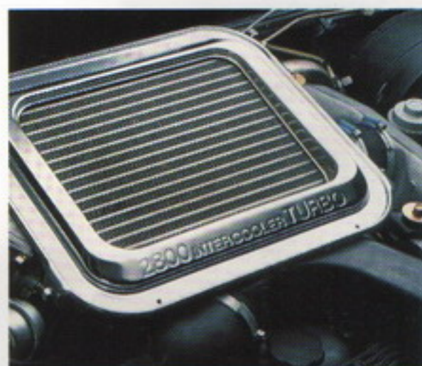
Wirtschaftlich, sparsam und leistungsstark: der 2.8-l-Turbo-Diesel mit Intercooler.
